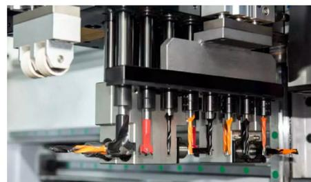
Компоновка верхней сверлильной группы: 12 – вертикальных шпинделей (8+4) ; 8 – горизонтальных шпинделей (4+4) Компоновка нижней сверлильной группы: 9-вертикальных шпинделей
