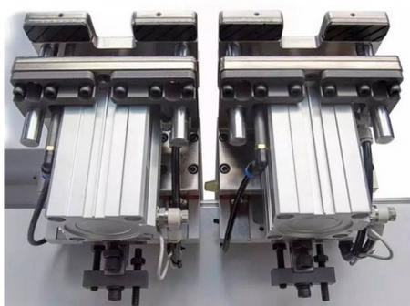
Два автоматических зажима позволяют надежно зафиксировать заготовку
