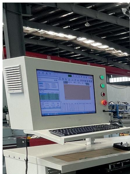
Станок оснащен промышленным компьютером Syntec
