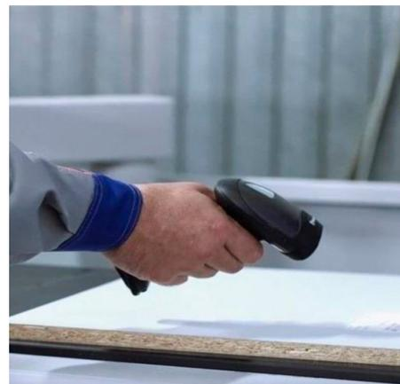
Сканер для считывания деталей в комплекте
