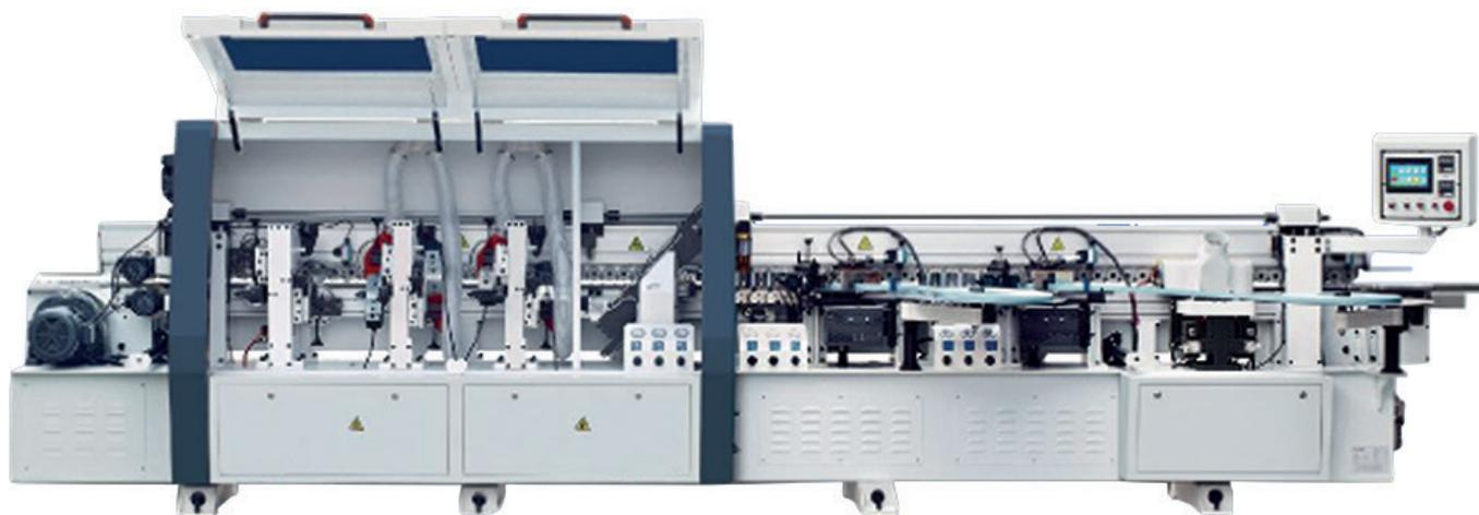
Предназначен для нанесения рулонного и полосового кромочного материала (толщина 0,4 - 3 мм), натурального или синтетического, на прямолинейные кромки заготовок из массива древесины, ламинированного ДСП, МДФ, а также различных композитных материалов на основе древесины. Переход с одного кромочного материала на другой происходит без предварительной переналадки станка. Система ROUND (закругление кромок) 90 / 180 / 360 градусов производится автоматически с помощью переключения на пульте управления.
