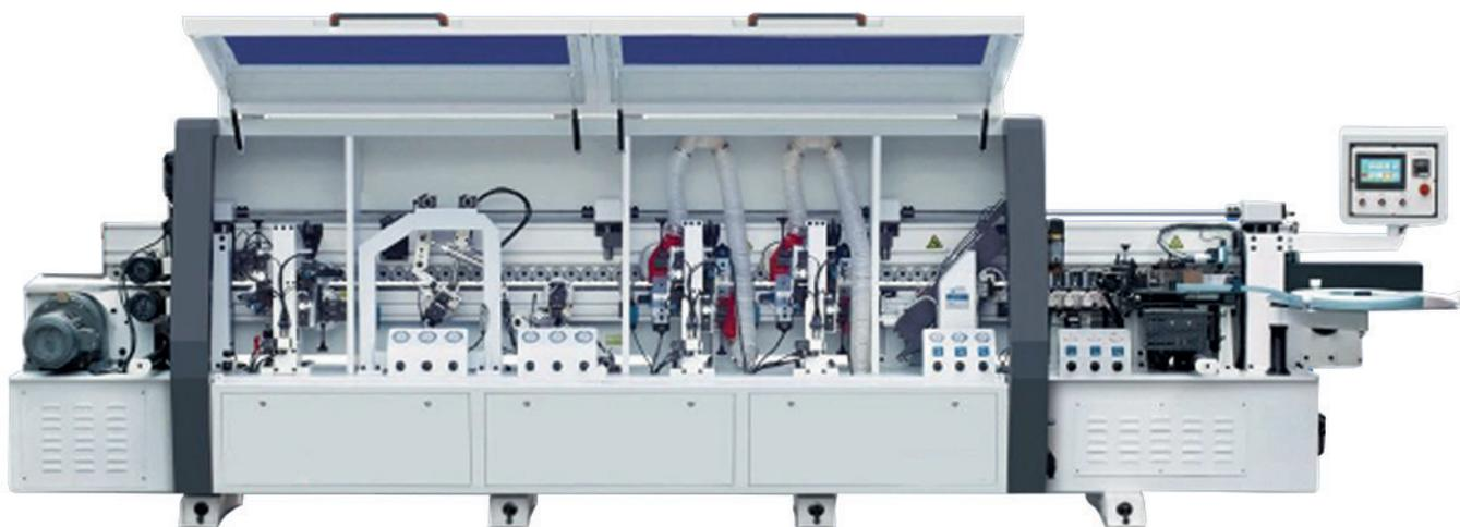
Кромкооблицовочный станок проходного типа FORMIGO предназначен для оклеивания кромочными материалами из ПВХ, меламина, шпона деталей из ДСП, МДФ и мебельных щитов, с последующей обработкой кромки и снятием свесов по длине, по торцам, фрезерованием, циклеванием и полированием.
