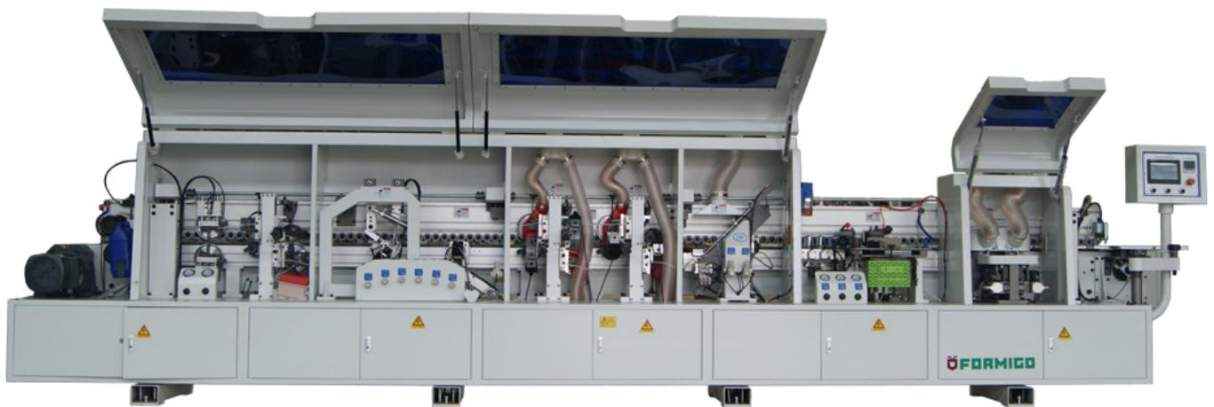
Кромкооблицовочный станок проходного типа FORMIGO предназначен для оклеивания кромочными материалами из ПВХ, меламина, шпона деталей из ДСП, МДФ и мебельных щитов, с последующей обработкой кромки и снятием свесов по длине, по торцам, фрезерованием, циклеванием и полированием.
