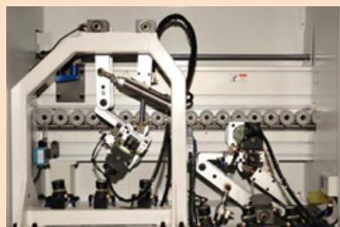
**Узел обкатки** оснащен двумя высокочастотными электродвигателями с универсальными фрезами, которые осуществляют обработку стыков кромки и придают изделию законченный вид.
