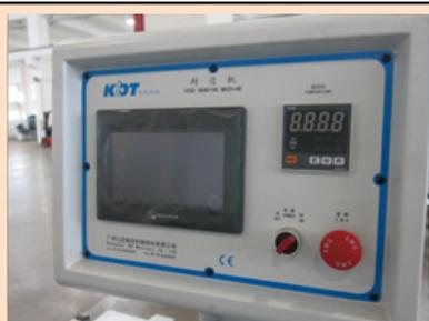
**Управление станком** осуществляется с помощью специального пульта оборудованным промышленным дисплеем с системой «Touch screen». Значки включения/выключения узлов и агрегатов на дисплее интуитивно понятны и не требуют специальных навыков для работы на станке.
