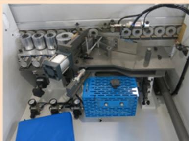
**Клеевая ванна** оснащена механизмом дозирования подачи клея.
