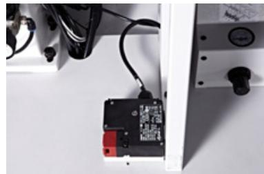
**Японские концевые выключатели OMRON** установлены на дверцах защитной кабины.
