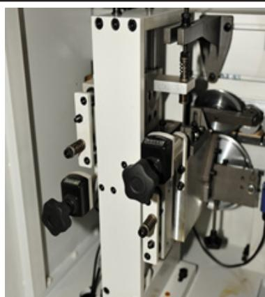
**Узел циклевания** оснащен двумя твердосплавными радиусными ножами, которые после фрезеровки кромки толщиной 2,0мм снимают тонкий слой с отфрезерованной части кромки в результате мы получаем ровную обработанную поверхность без каких-либо дефектов.
