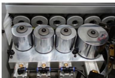
**Давление на пресс группе** задается с помощью пневматики, что гарантирует равномерное распределение усилий на кромку во время приклеивания
