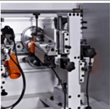
**Фрезерный узел** состоит из двух высокочастотных электродвигателей оснащенных фрезами с прямыми ножами, которые позволяют обрабатывать кромочный материал толщиной 0,4 – 3,0 мм. Деталь отслеживается с помощью двух круглых копиров (на каждом моторе) установленных на плавающем узле, это конструкция предотвращает появление брака во время фрезеровки.
