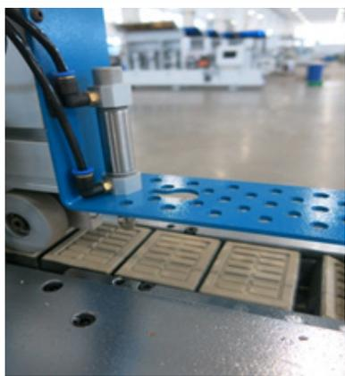
**Шток дозатор** подачи заготовок, предотвращает повреждения узлов станка во время работы
