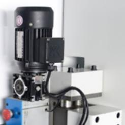
**Механизм подъема/опускания прижимной траверсы** оснащен электроприводом, что обеспечивает быструю и точную установку на необходимую толщину детали.
