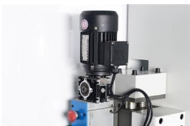
**Механизм подъема/опускания прижимной траверсы** оснащен электроприводом, что обеспечивает быструю и точную установку на необходимую толщину детали.
