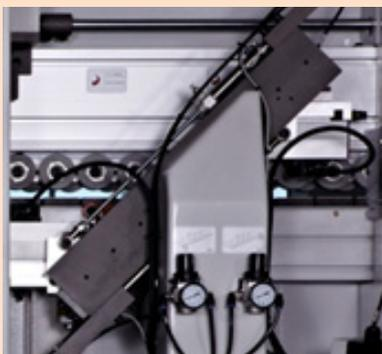
**Узел чистовой торцевой обрезки** оснащен двумя высокочастотными электродвигателями. Перемещение пильных узлов осуществляется по специальным линейным направляющим.
