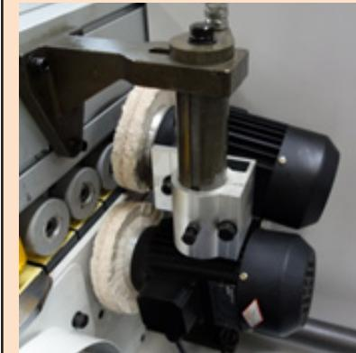
**Узел полировки** осуществляет полировку обработанной части кромки после операций фрезерования и циклевания.
