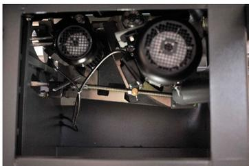
Раздельные мощные приводы на основную и подрезную пилу
