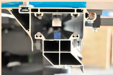
Усиленная роликовая каретка со стальными цилиндрическими направляющими обеспечивает точность и качество распиловки. Практика и основные производители показывают, что на сегодняшний день такой тип каретки наиболее надежен и долговечен
