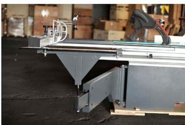
Станина имеет жесткую сварную конструкцию
