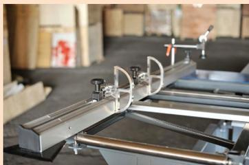
Линейка для большего удобства оснащена откидными упорами и линзами
