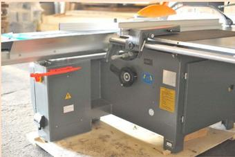
Комплектующие надежно спрятаны в отсек в станине станка.
