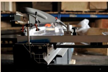
Станок дополнительно оснащен чугунным эксцентриковым прижимом для надежной фиксации
